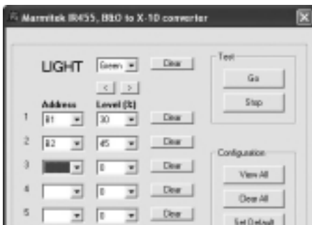
Die grüne Taste muss Modul B1 auf 30% und Modul B2 auf 45 % einstellen
